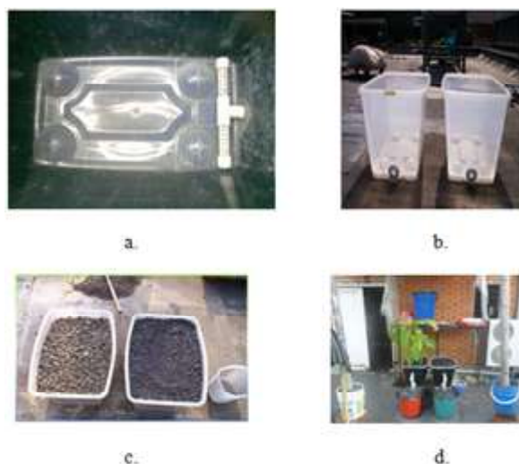
Figura 1. Sistema de tratamiento de humedales. a. Tubería de drenaje en HFSS. b. Estructura de los contenedores en polipropileno. c. Contenedores con el medio granular. d. Sistema de humedales de flujo subsuperficial.
